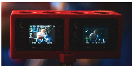
Abbildung 4: 3D-Gedrucktes Side-by-Side Rig mit zwei RX0 3 Kameras
